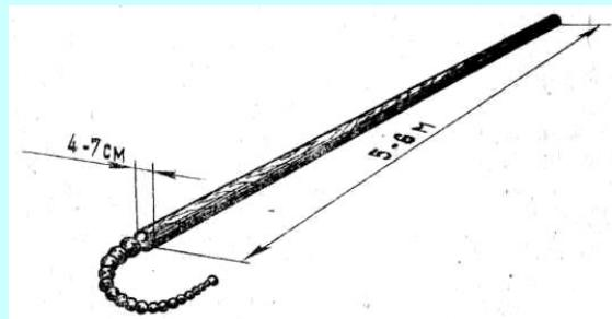
Рис. 10. Спасательный багор
